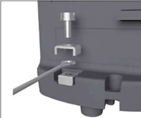
Verbinden Sie die Waage mit einem Potenzialausgleichskabel von mindestens 4 mm<sup>2</sup> Querschnitt mit dem Potenzialausgleich.
