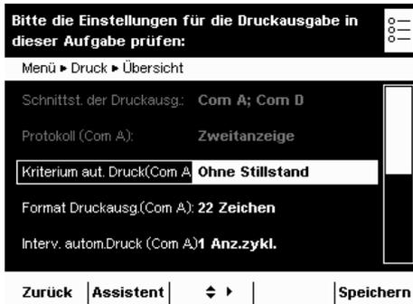
▷ Als Zweitanzeige soll automatisch im vorgegebenen Intervall an das angeschlossene Peripheriegerät ausgegeben werden.
