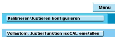
**isoCAL:** Funktion festlegen: Ausgeschaltet/nur Warnstufe, manuelle Auslösung/\*Eingeschaltet, automatische Ausführung
