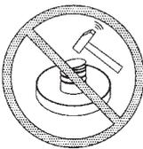
Auf keinen Fall die Farbdose mit dem Hammer verschließen, solange die Farbdose noch auf der Lastplatte steht! Das Wägesystem wird beschädigt!
